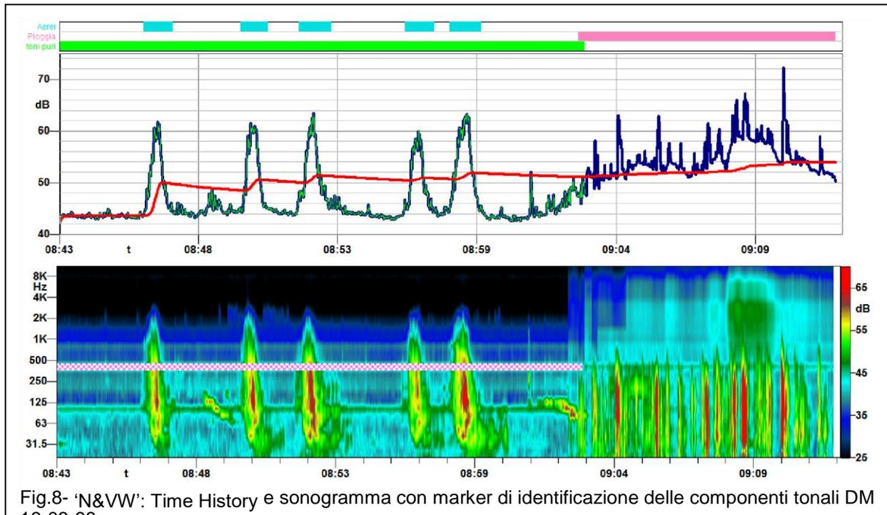
L'attivazione del Marker per le componenti tonali consente di individuare ed evidenziare tutti i periodi di presenza di una tonale anche su misure di lunga durata e per qualsiasi banda in frequenza compresa tra 20 Hz e 20 kHz; il solo parametro che deve essere impostato dall'operatore per questa ricerca è la durata minima su cui si desidera venga individuata la componente tonale.
