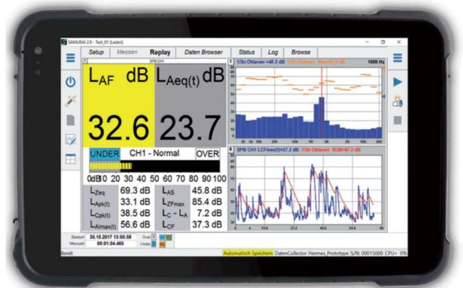
Al fine di agevolare la documentazione dei dati acquisiti, il dispositivo è dotato di GPS per la geo-referenziazione delle misure mentre l'interfaccia 3G consente il completo controllo remoto e/o l'invio automatico dei dati in tempo reale tramite SIM entro-contenuta.
