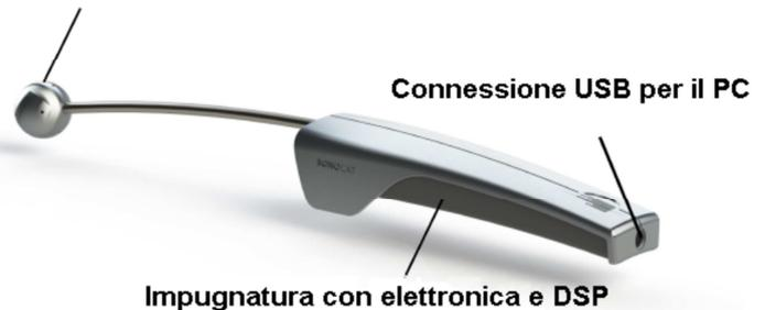
Grazie alla forma sferica del trasduttore è stato possibile modellarne l'interazione con il campo acustico e compensarne quindi l'effetto.
