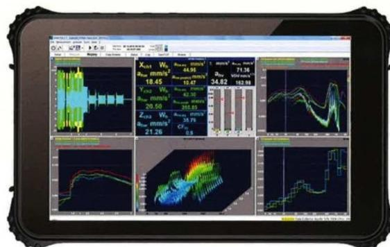
NoisePAD® con il software SAMURAI®, oltre ad essere un analizzatore FFT evoluto, è un fonometro a 4 canali conforme allo standard IEC 61672 con filtri in terzi di ottava in tempo reale in classe 0 conformi allo standard IEC 1260. NoisePAD® consente la registrazione di segnali fino a 20 kHz di larghezza di banda.
