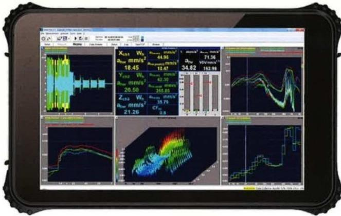
A seconda delle opzioni software installate, sullo schermo di NoisePAD® è possibile rappresentare direttamente forme d'onda, time histories, spettri FFT, spettri a banda percentuale costante (1/1, 1/3, 1/12, ecc..), analisi d'ordine, waterfall, sonogrammi, parametri fonometrici.
