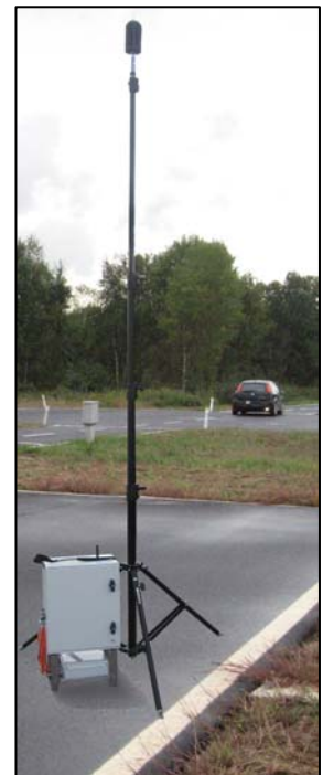
Stazione di monitoraggio semifissa cabinet e treppiede per microfono
