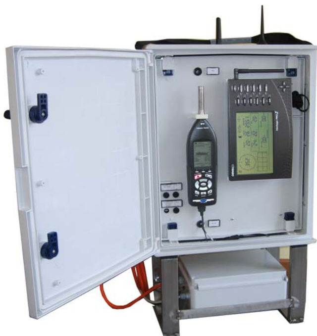
Stazione autonoma per il monitoraggio del rumore e dati meteo
